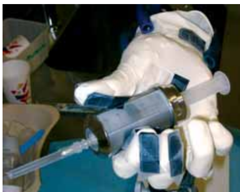
Disposition des dosimètres pour mesurer l'exposition des doigts lors de l'utilisation d'un protège-seringue en médecine nucléaire.
