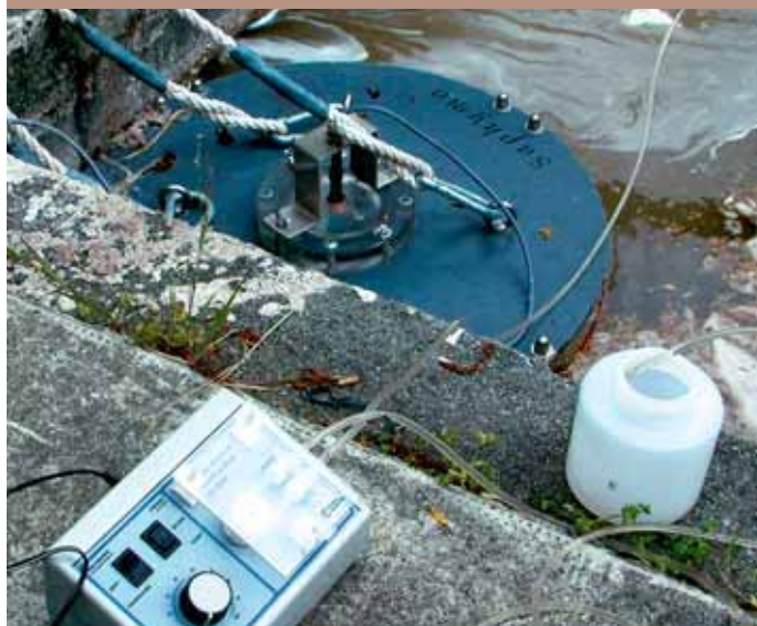
Sonde Téléhydro portable immergée à la sortie d'un collecteur d'eaux usées d'un hôpital toulousain.
