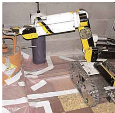
Certaines interventions nécessitent la mise en œuvre des moyens de téléintervention de l'IRSN. Ici le robot Romain.
