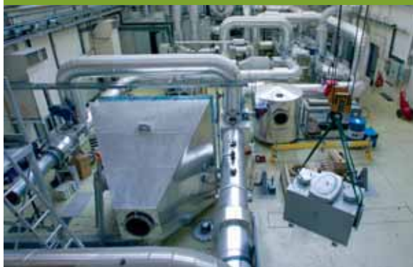
Soufflante à l'échelle 1 pour tester la résistance aéraulique et mécanique des équipements de sectorisation.
