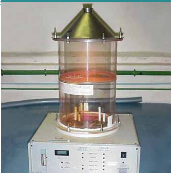
Appareil de traçages gazeux et particulaire mis en œuvre par l'IRSN.
