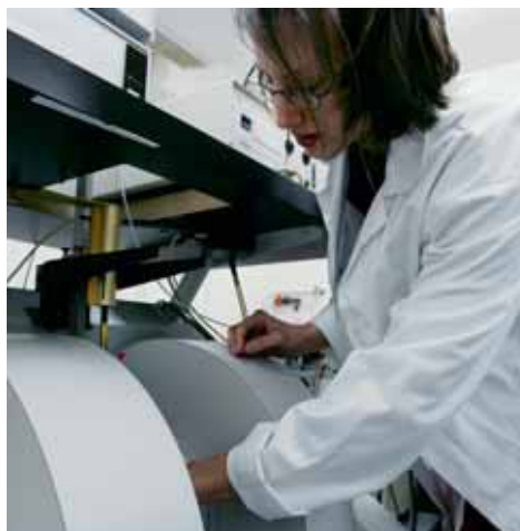
Spectromètre utilisé pour les mesures en Résonance paramagnétique électronique (RPE).
