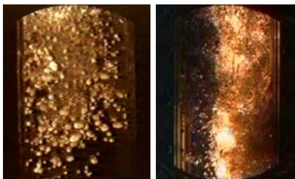
Figure 4.3-2 : Visualisation de pré-mélanges Alumine/eau (à gauche, KROTOS-57) et corium/eau (à droite, KROTOS-58). Caméra vidéo 24 im/s, fenêtre 10x20 cm. Extrait de [4.3_1]
