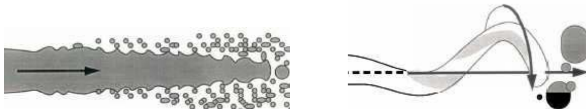
Figure 4.3-3: Régimes d'instabilité/fragmentation par atomisation (gauche) et grande échelle (droite)
