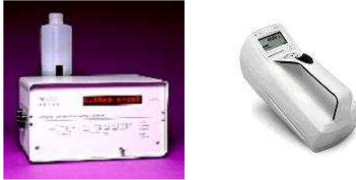
Figure VI-1 : Exemples d'équipements avec à droite un nouveau modèle de CNC transportable TSI permettant la détection des nanoparticules de tailles supérieures à 10 nm, concentration maximale de 5 \times 10^5 p/cm 3
