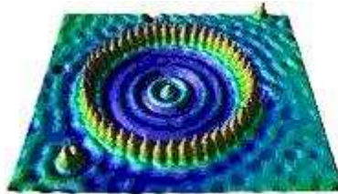
Figure V-4 : Illustration de structures obtenues après manipulation atomique à l'aide d'une pointe AFM.
