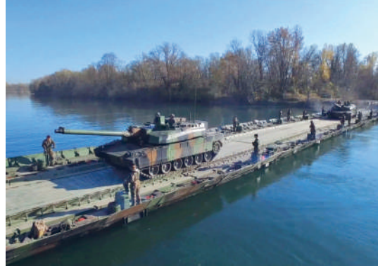
Chars Leclerc sur un Pont Flottant Motorisé (PFM) de 160 mètres de long
