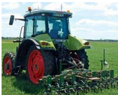
bineuse équipée d'un système RTK .site triple performance.
