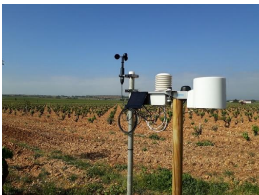
Photo : site agro ressource. Station météo connectée
