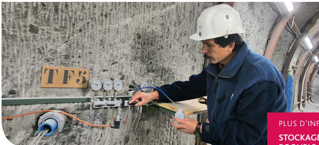
Prélèvement d'eau pour analyses géochimiques en tête d'un dispositif chimiquement inerte et isolant une fracture transmissive dans la station expérimentale de Tournemire (Aveyron).
