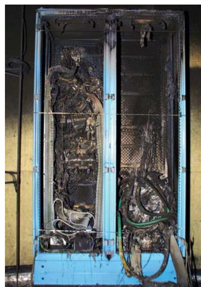
Armoire électrique après un essai PICSEL EP dans l'installation DIVA.
