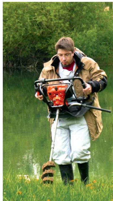
Tarière mécanique pour prélèvement de terre.
