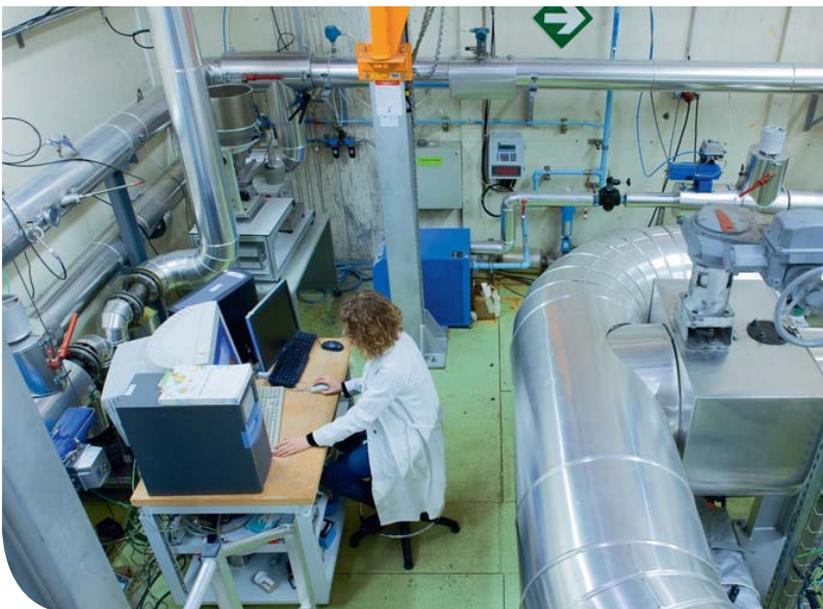
Le banc d'essai CATFISH, à Saclay (Essonne), permet d'acquérir des données analytiques sur le colmatage des filtres THE.
