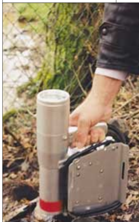
Mesures des rayonnements ionisants sur le site de l'entreprise Orflam-Plast.
