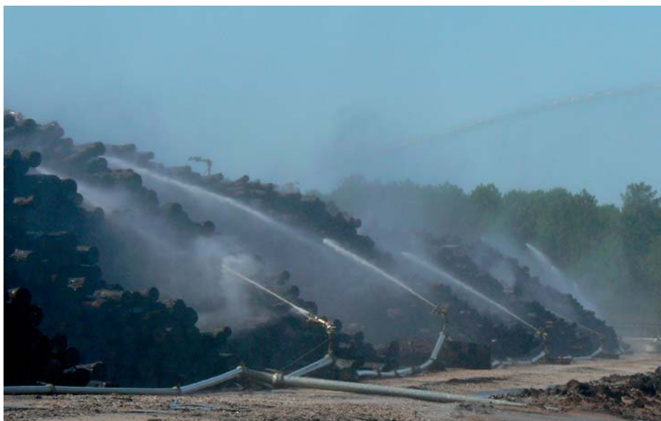
Figure 44 – Stockage et conservation sous aspersion de bois sinistrés (ici par la tempête Klaus de 2009 en Aquitaine)
