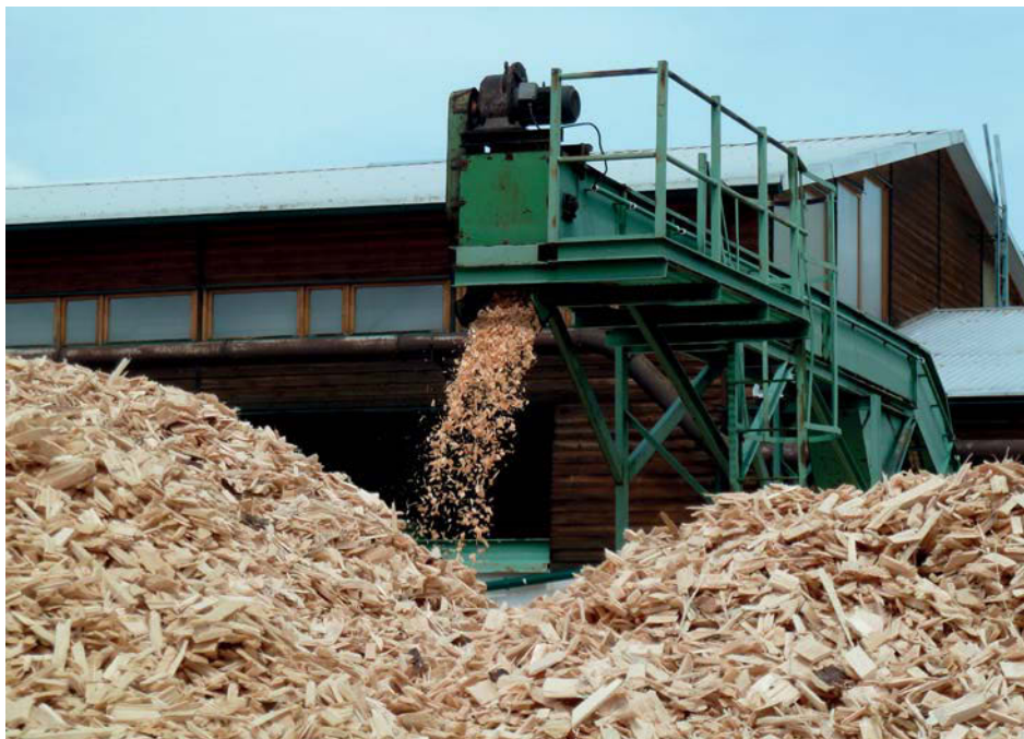
Figure 39 – Production de plaquettes de bois pour la trituration ou l'énergie à partir des chutes de bois d'une scierie
